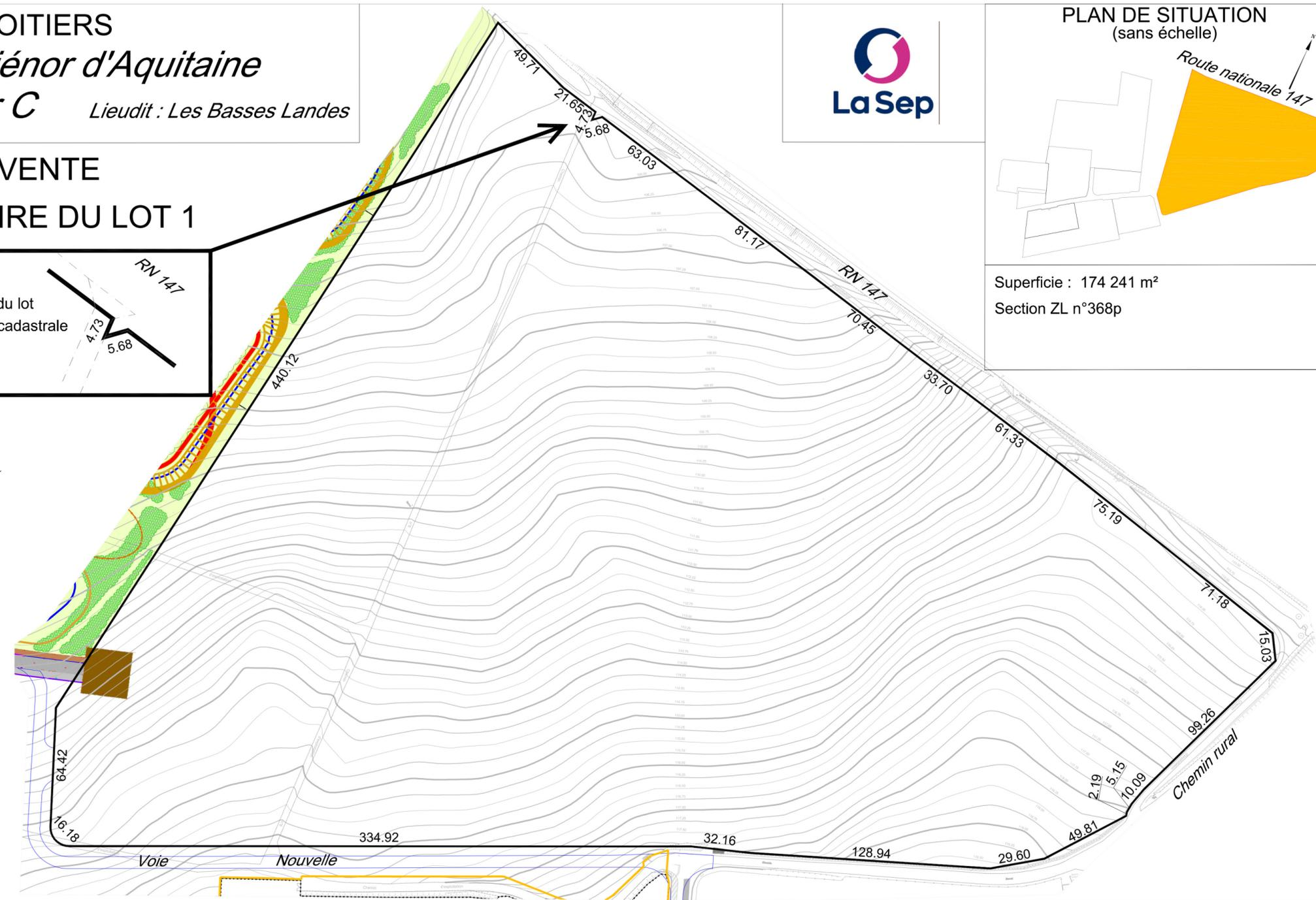
Nota : Nivellement rattaché au système altimétrique NGF IGN 69 Nota 2 : La surface et les cotes ne seront définitives qu'après bornage du lot
